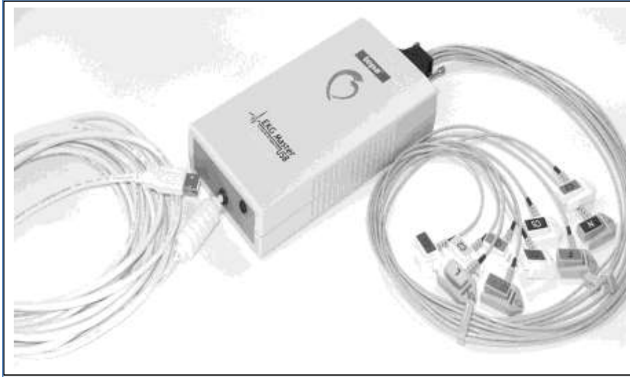
Şekil 1.1. EKG Hasta kablosu ve USB bağlantı kablosu ile beraber EKG Master USB cihazının görünümü
